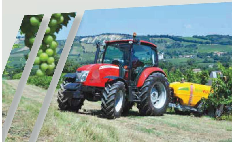
A série X4 é composta por seis modelos com motores de 4 cilindros nas variantes F e XL com potência dos 70 aos 112 Cv. Com várias opções de caixa, inversor mecânico ou electro-hidráulico, possibilidade de eixo dianteiro com suspensão, distribuidores com comando eletrónico ou hidráulico e TDF frontal. *Pensados para a vitivinicultura e fruticultura os agricultores encontram na série X4 a solução à medida da sua exploração.*
